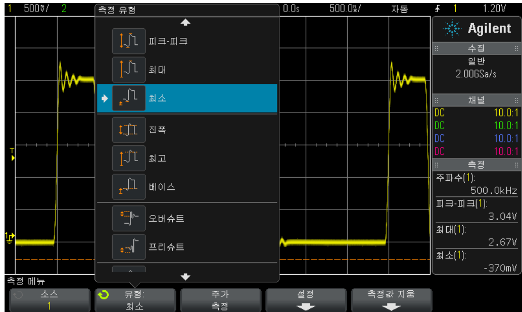
그림 32 스코프가 자동으로 최대 4 개의 파라미터를 측정합니다.
