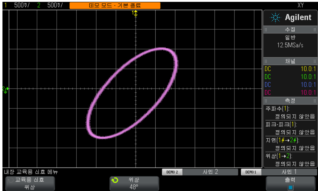
그림 40 주파수는 같지만 서로의 위상 차이가 48 도인 두 사인파가 있는 스코프의 XY 모드를 사용하는 Lissajous 패턴
